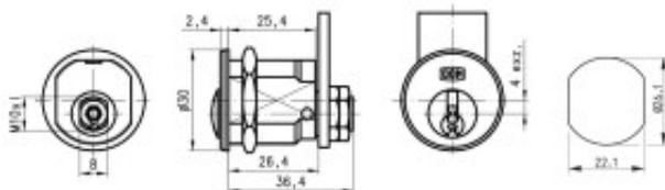
Hebelzylinder 382 in RS 7 Si verschiedenschließend mit 3 Eigenschlüssel
