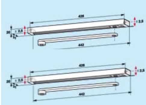
Gleitschiene G-N DORMA
